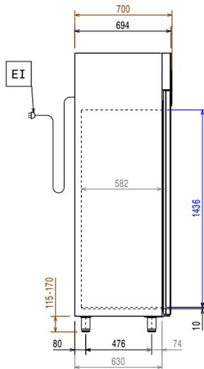
EI = Conexión eléctrica (energía)
